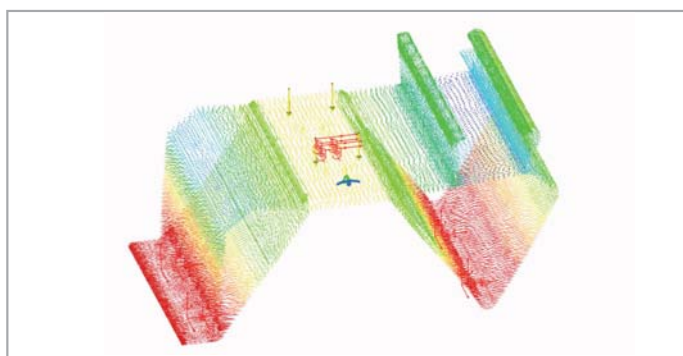
Simulation par éléments finis des contraintes de compression dans le cavalier
