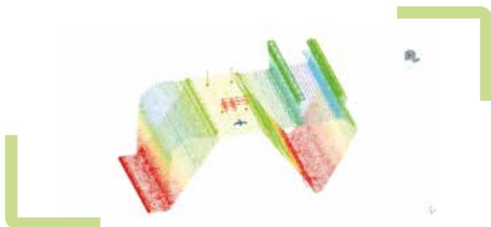
Simulation par éléments finis des contraintes de compression dans le cavalier
